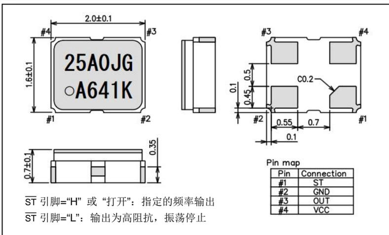
$\overline{ST}$  引脚="H" 或 "打开": 指定的频率输出
