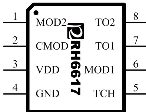
图 1 SOP8/DIP8 引脚示意图
