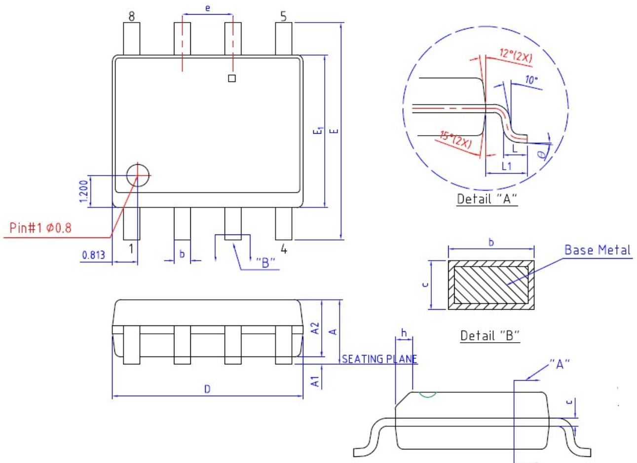
图3 SOP8封装图
